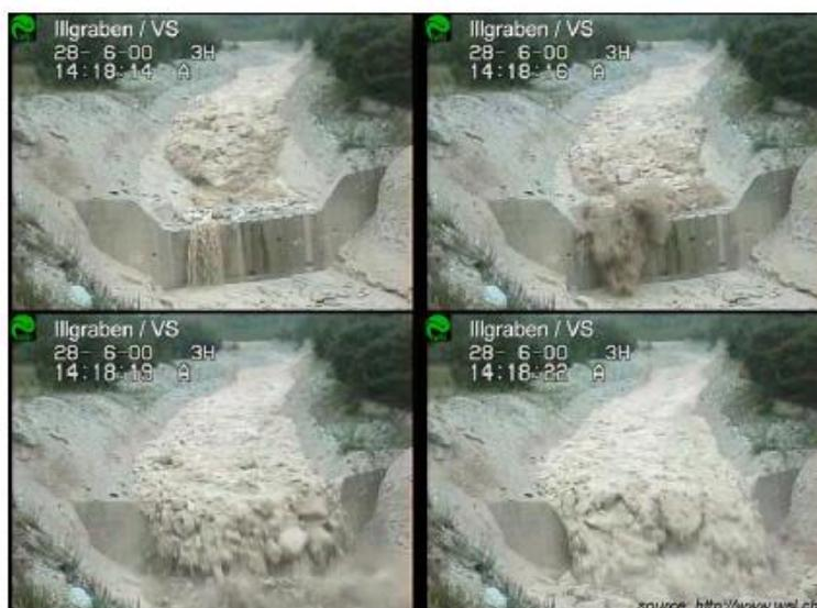
Fig. 3 – Passage d'une importante lave torrentielle dans le chenal de l'Ilgraben (VS) le 28 juin 2000. Le chenal mesure environ de 20m de large et le mur 6m de haut. Entre la première et la quatrième image, il ne s'est écoulé que 8 secondes ! Notez la taille des blocs transportés (source : <http://www.wsl.ch>).
